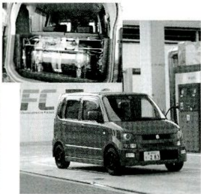
コンバージョンキット(写真左 上)は軽自動車にも搭載可能
